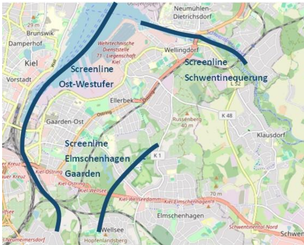
Abbildung 17: Screelines zur Auswertung der Gesamtverkehrsmengen über die Schwentine, zwischen Ost- und Westufer und zwischen Elmschenhagen und Gaarden
